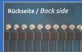
Lötpunkte mit SR-HS Solder points with SR-HS
