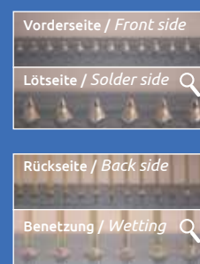
Lötunkte mit SR-HS Solder points with SR-HS
