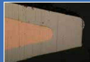
Seitenansicht nach 20.000 Abschmelzvorgängen bei 380°C side-view after 20,000 melting procedures at 380°C
